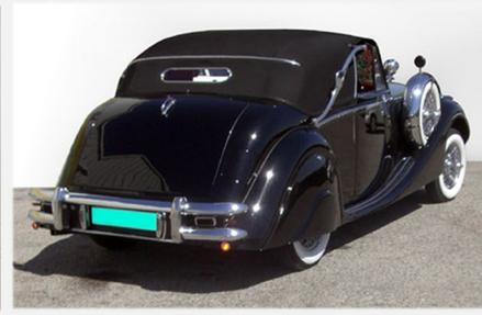
El modelo Mark V de la marca británica, se fabricó entre 1.948 y 1.951. Esta unidad lleva el motor más grande de los dos que montaba este modelo con 3.485cc., 6 cil. y 126 cv.
